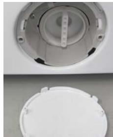
Рекомендуется очищать фильтр насоса через ок. 20 стирок. Несвоевременная очистка фильтра приводит к засорению фильтра и затрудняет слив воды из машины!
